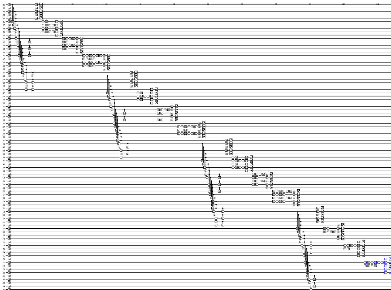
図 A.15: 非隣接ゲートの出力 (4 量子ビット離れた CNOT ゲート)Brickwork 版
