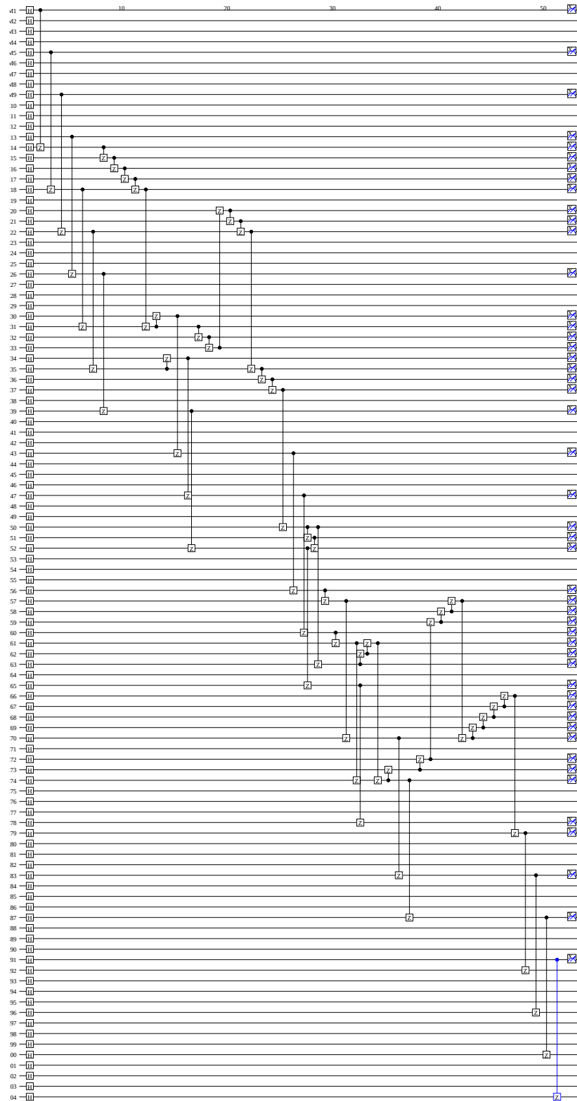
図 A.6: 非隣接ゲートの出力例 (3 量子ビット離れた CNOT ゲート) : MBQC 版
